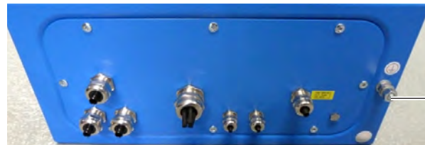
PEボルト キャビネット下側
