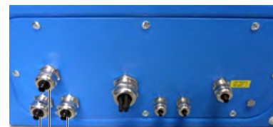
Kabelverschraubungen M20 für MUX-Leitungsstrang
