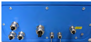
ケーブルねじM12 リレー信号ケーブル用
